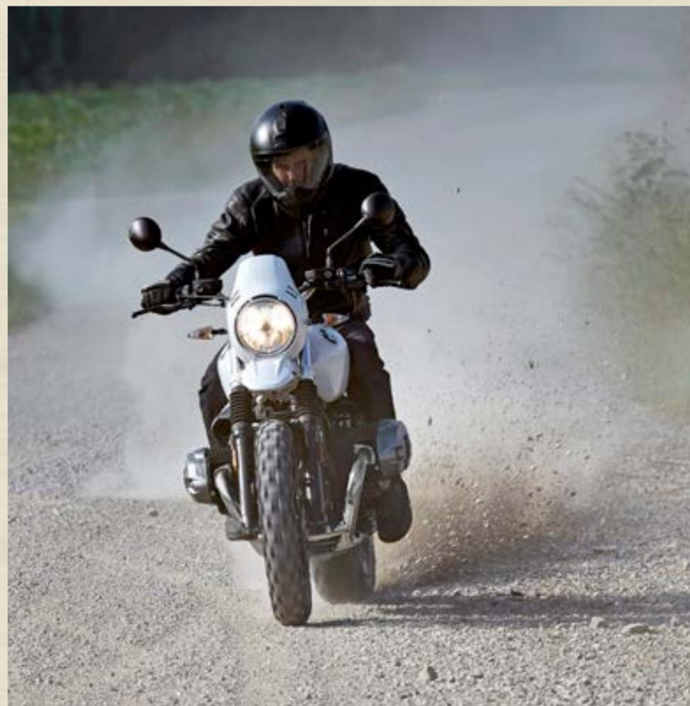
► La nueva GS, propulsada por el conocido boxer refrigerado por aire/aceite de 1700 c.c. y 110Cv de potencia, y con una parte ciclo equipada con horquilla telescópica convencional, Paralever trasero con amortiguador central, y llantas de radios, ofrece una gran variedad de posibilidades de personalización
