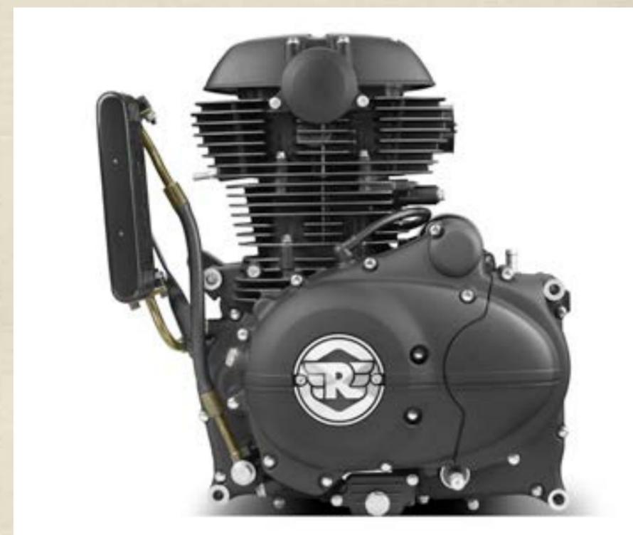
▶ El propulsor de la Himalayan es un motor de carrera larga con árbol de levas en culata con mucho par a bajas revoluciones, lo cual nos permitirá una conducción suave en marchas largas que facilita los ascensos en pistas y las maniobras entre el tráfico denso. Gracias a su nuevo diseño y a la calidad y ligereza de los materiales elegidos para su fabricación, el
