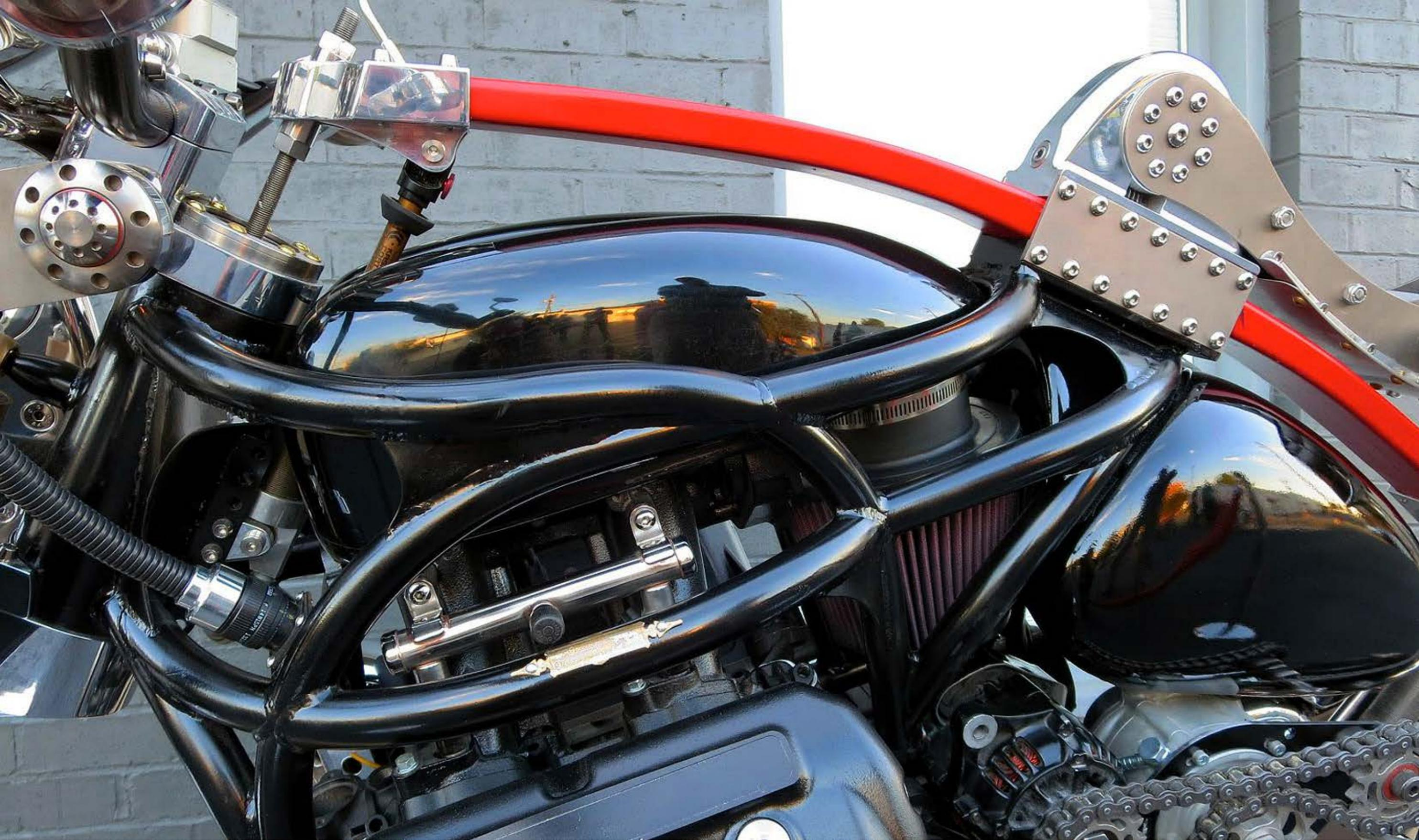
El diseño del bastidor es un entramado de tubo de acero al cromo molibdeno construido a medias entre el propio Nesbitt y Ace Breaux, y cuenta con sutilezas como la posibilidad de modificar el ángulo de los faros y las alturas
