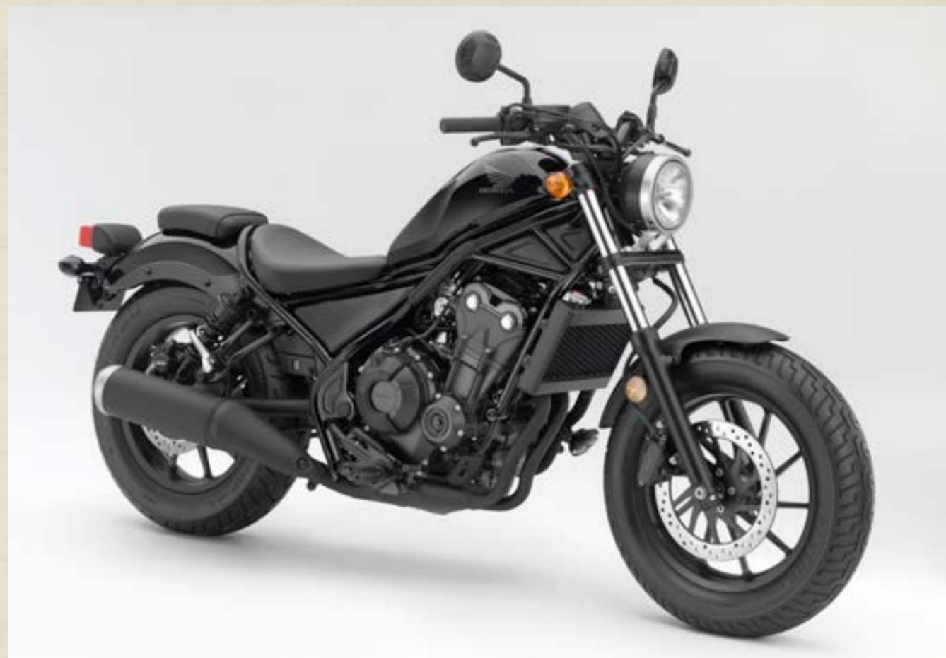
▶ Un nuevo bastidor de acero tubular traza unas líneas modernas y originales de estilo 'bobber', con la parte trasera desnuda y equipada con un neumático de perfil ancho. El vigoroso motor de la Rebel, un bicilíndrico en paralelo de 471cc, 8 válvulas y refrigeración líquida, apto para el carnet
