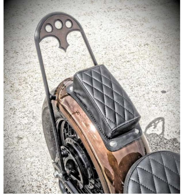
En su lugar ahora nos encontramos un guardabarros de chapa cubriendo el neumático Dunlop de 170mm de ancho -que no tardará en engordar hasta 200mm porque tanto la llanta como el basculante lo admiten sin problema- sujeto al chasis por un sissy bar artesanal. La chapa en la que está hecho tiene suficiente grosor como para aguantar el peso de un acompañante, por lo que el asiento para el pasajero no solo está más que
