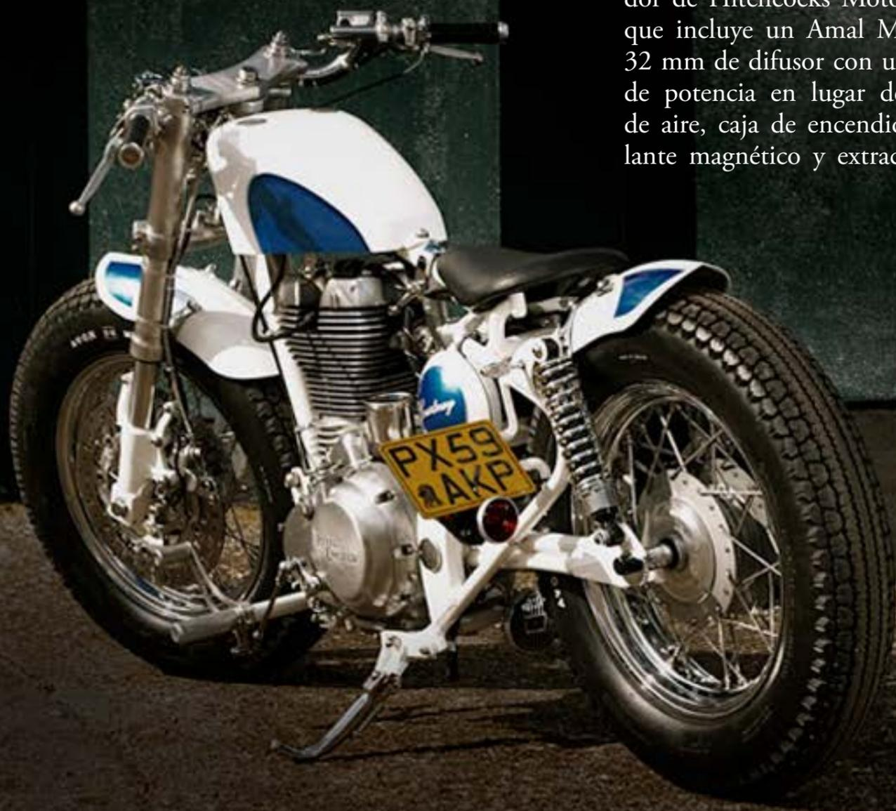
Para aprovechar al máximo las cualidades de la parte ciclo, Alec decidió potenciar el motor con un kit de conversión a carburador de Hitchcocks Motorcycles que incluye un Amal MK1 de 32 mm de difusor con un cono de potencia en lugar de filtro de aire, caja de encendido, volante magnético y extractor. El
