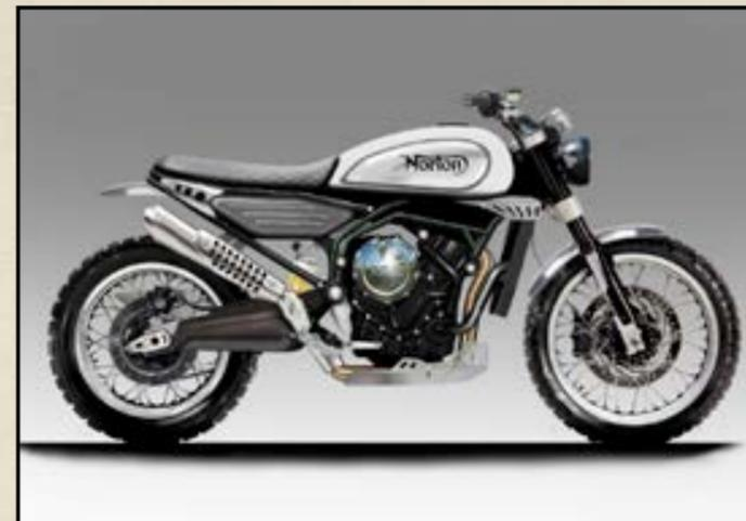
Tras sus modelos **Commando**, **Dominator** y **V4 RR**, la marca británica está preparando una nueva gama de modelos propulsada por un ligero y moderno bicilíndrico paralelo de 650cc basado en el de las V4 (es justo la mitad de este) cuya arquitectura permitirá hacer unas motos muy *cortas y compactas*.
