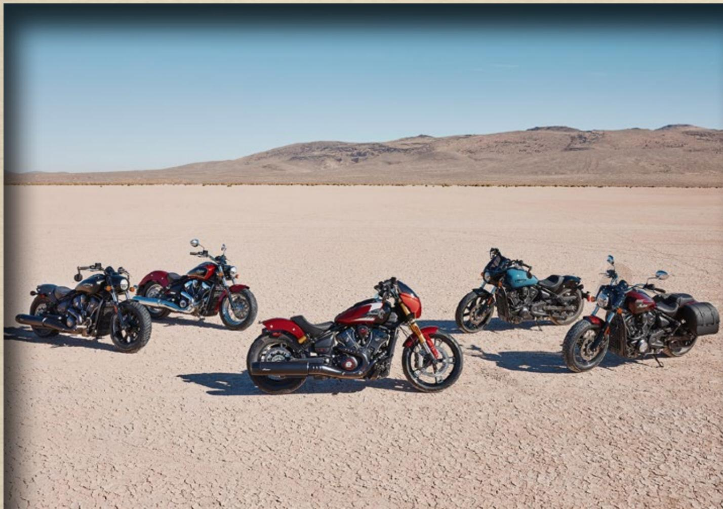
El corazón de las nuevas Scout es un nuevo motor Speed Plus de 1250 cc y refrigeración líquida, que con sus 82 kW ofrece más aceleración y potencia que sus antecesoras gracias también a una inyección electrónica rediseñada que proporciona una respuesta muy suave del acelerador, y un cambio de seis relacio-
