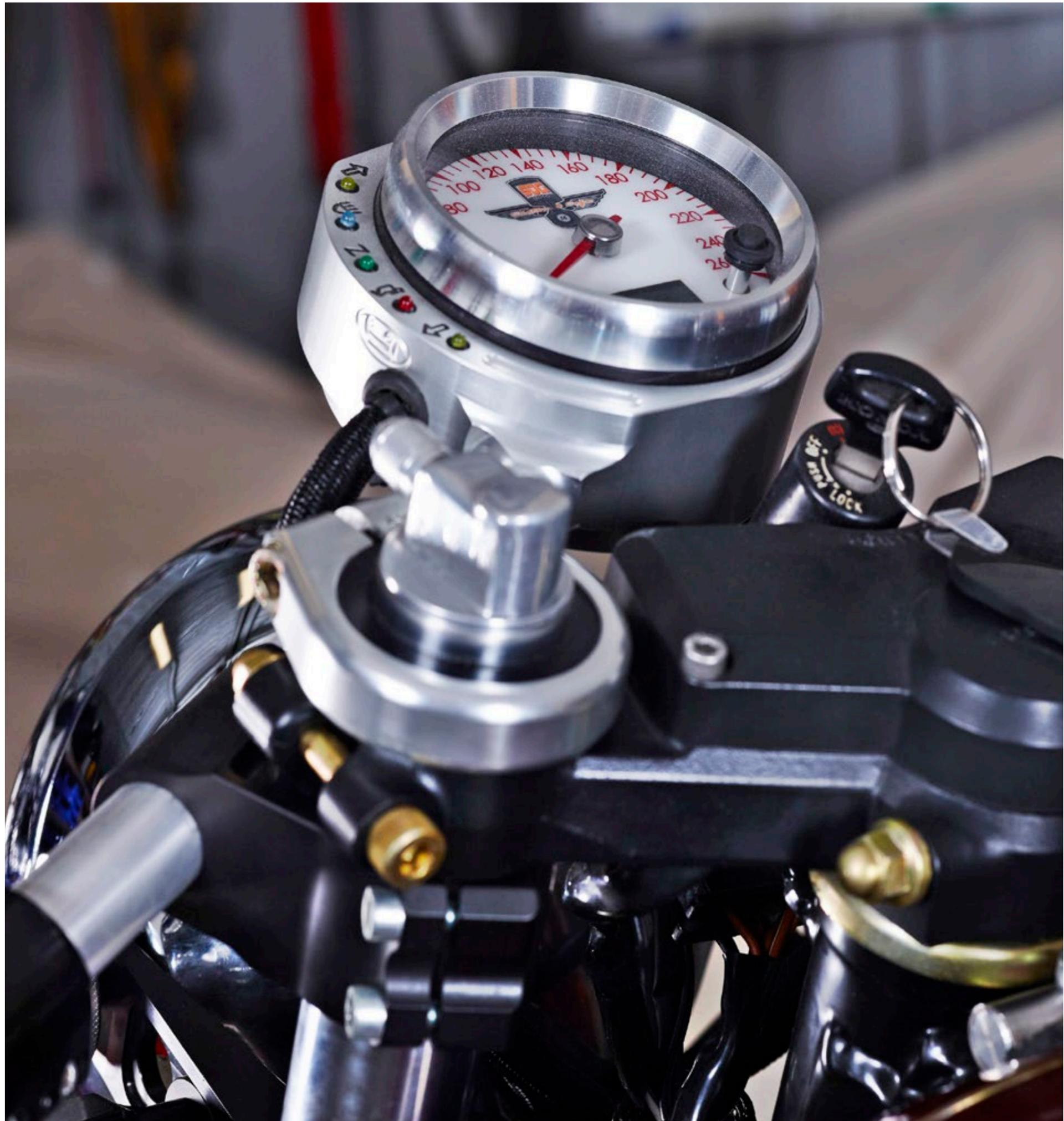
El tren delantero de la Honda se ha restaurado reconstruyendo la horquilla con nuevos muelles e hidráulicos, cambiando los latiguillos de freno por unos Earls de acero inoxidable y aligerando los discos de freno originales.
