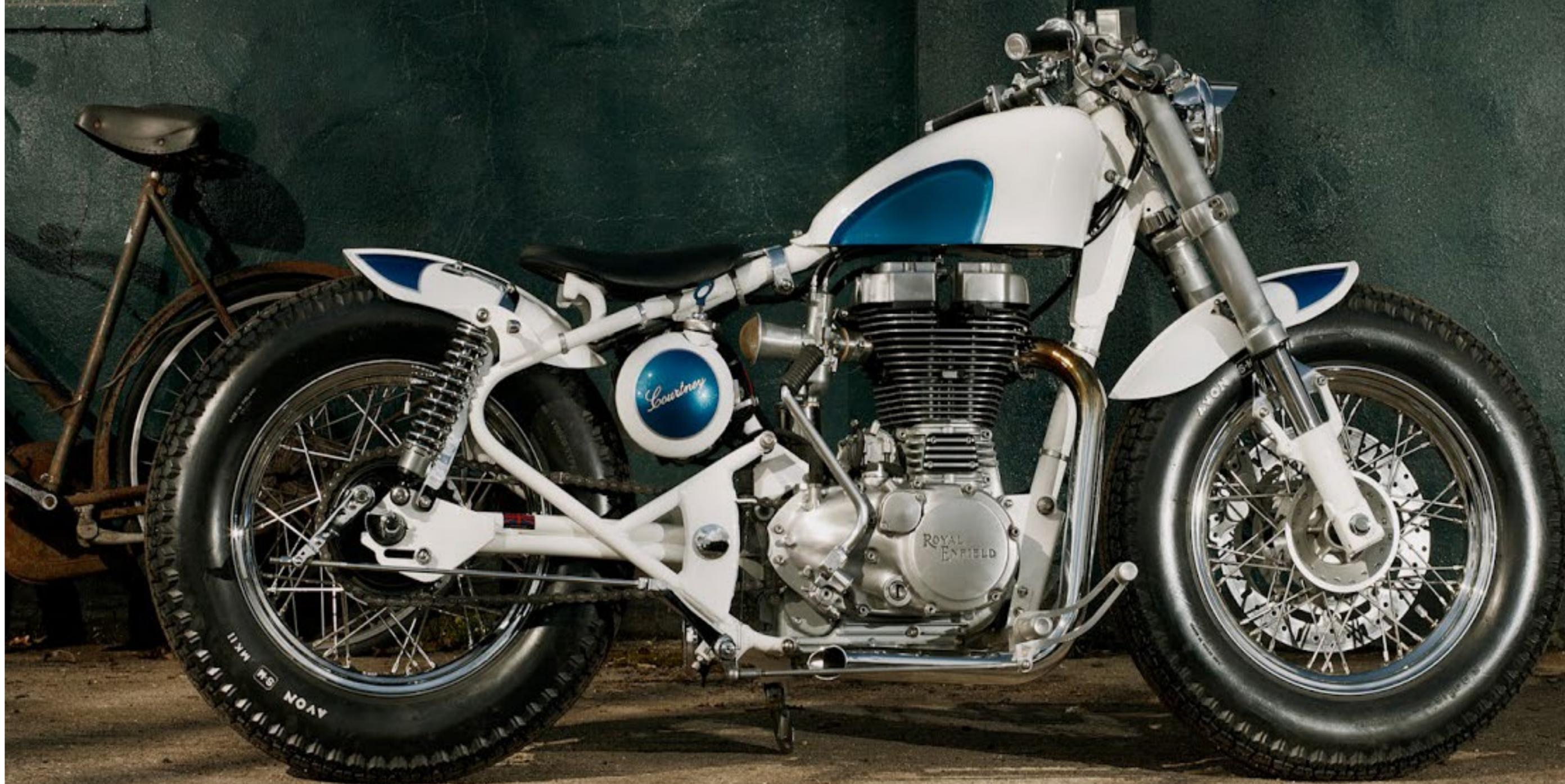
Para aprovechar al máximo las cualidades de la parte ciclo, Alec mejoró el rendimiento del motor instalándole un kit de Hitchcocks Motorcycles que permite sustituir la inyección electrónica de serie por un carburador Amal MK1 de 32 mm de difusor con un cono de potencia en lugar de filtro de aire, que también incluye una nueva caja de encendido, volante magnético
